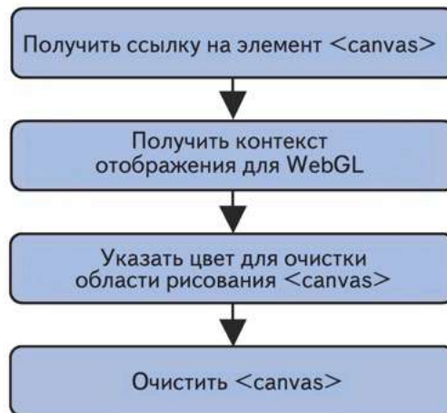
Рис. 2.8. Порядок работы функции main()
