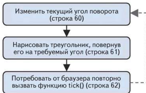
Рис. 4.8. Действия, выполняемые в функции tick
