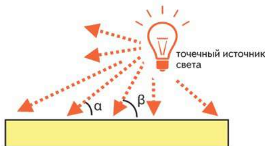
Рис. 8.16. Направление на точечный источник света различается в разных точках
