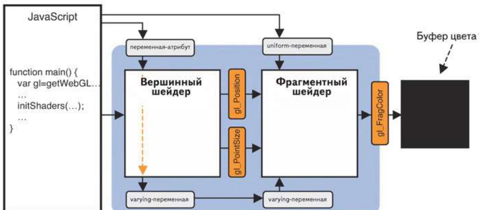
Рис. 2.30. Два способа передачи данных во фрагментный шейдер
