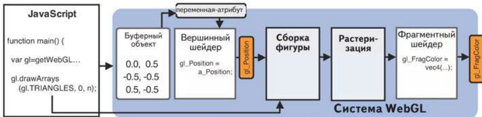
Рис. 5.10. Операции сборки и растеризации между вызовами вершинного и фрагментного шейдеров
