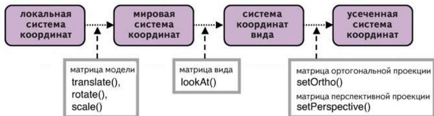
Рис. G.5. Преобразования и системы координат
