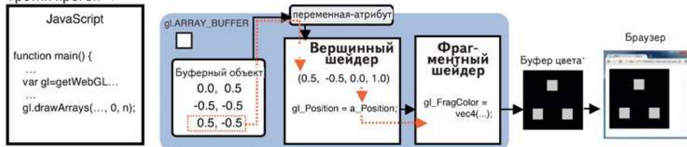
Рис. 3.11. Так данные из буферного объекта передаются в вершинный шейдер
