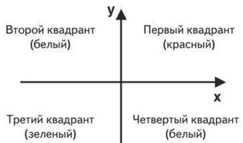
Рис. 2.32. Нумерация квадрантов в системе координат и соответствующие им цвета
