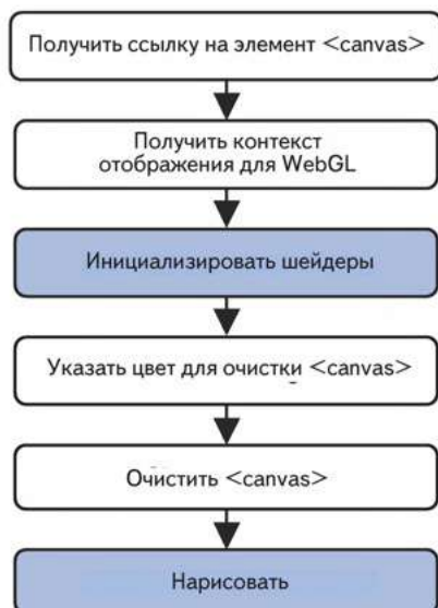
Рис. 2.13. Последовательность операций, выполняемых WebGL-программой
