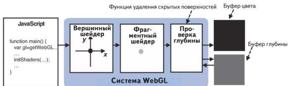
Рис. 7.29. Буфер глубины используется механизмом удаления скрытых поверхностей
