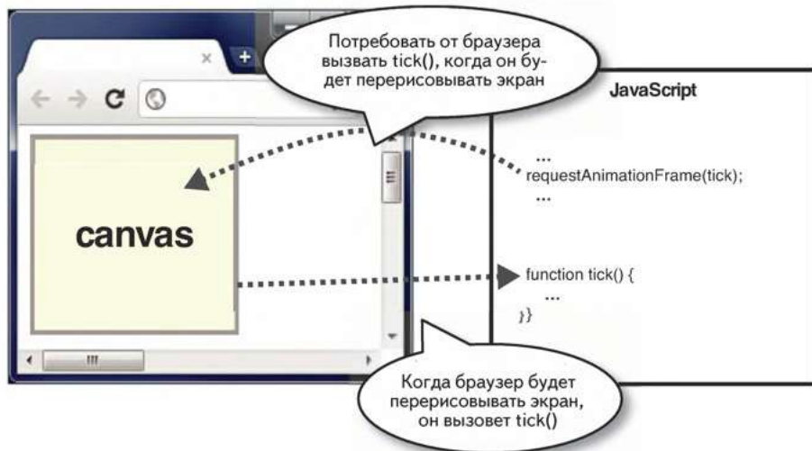
Рис. 4.9. Механизм действия requestAnimationFrame()
