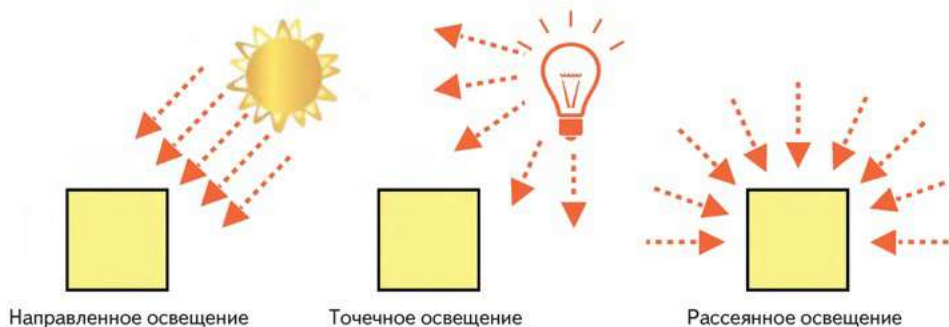
Рис. 8.2. Направленный свет, точечный свет и рассеянный свет
