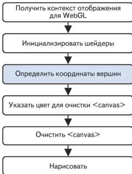
Рис. 3.3. Последовательность операций, выполняемых программой MultiPoints.js
