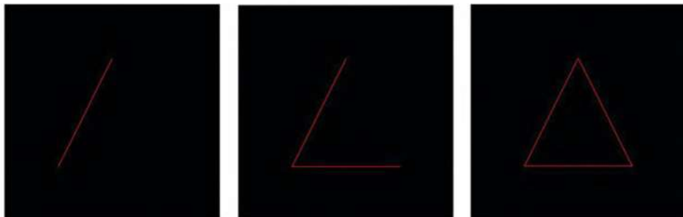
Рис. 3.14. gl.LINES , gl.LINE_STRIP и gl.LINE_LOOP
